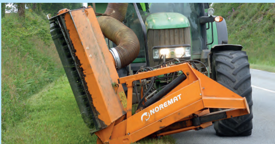
Broyeur-aspirateur latéral. © Cerema
