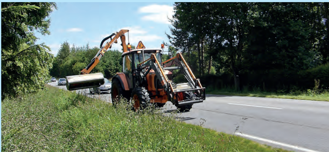
Gestion des accotements en pointillés ou ponctuelle par épareuse (100 m sans broyage tous les km). © Cerema
